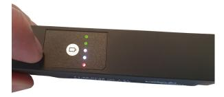
Die verbleibende Kapazität wird insgesamt durch fünf LEDs angezeigt, wobei jedes 20 % der Akkukapazität signalisiert.
